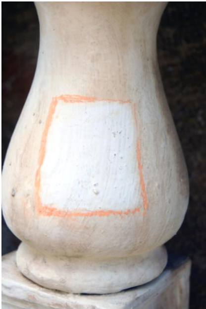
Εικ.217 Δοκίμιο ΔΚ1 καθαρισμός με απιονισμένο νερό
