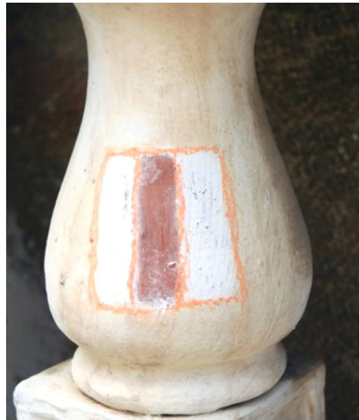
Εικ. 218 Δοκίμιο ΔΚ1, εφαρμόστηκαν από αριστερά: απιονισμένο νερό, ακετόνη, white spirit
